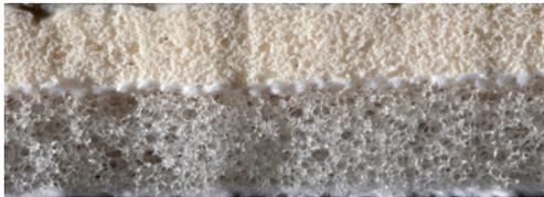
**Adhesion-EXTREME-Haftschaum** ist eine Weiterentwicklung des ADHESION-Haftschaums. Er besteht aus 3-mm Naturlatex-Haftschaum und 3-mm-Sandwich-Foam. Sehr weicher Haftschaum mit perfekter Dämpfung, besonders empfehlenswert bei Regen und nassen Wetterbedingungen, garantiert optimale Griffigkeit. Haftschaum für professionelle Torhüter.
