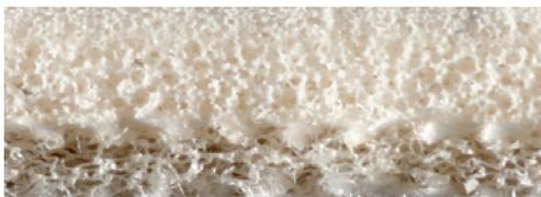
**Dura-Grip-Haftschaum** aus Naturlatex-Haftschaum und Sandwich-Foam. Speziell entwickelter Haftschaum mit sehr gutem Grip und guter Dämpfung. Je nach Modell ohne Struktur (glatte Oberfläche) oder mit Struktur (raue Oberfläche). Für den Gebrauch bei allen Platz- und Witterungsbedingungen.
